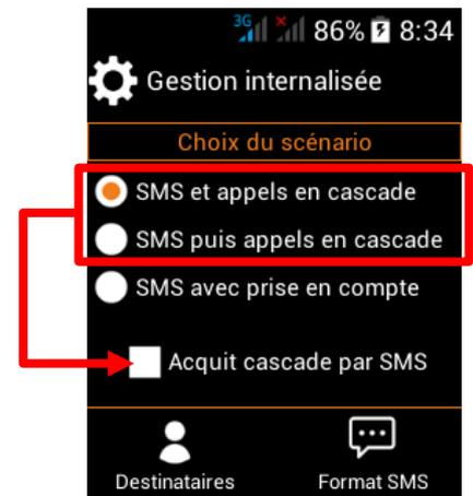
**FO** Si le paramètre « Acquit cascade par SMS » est coché, la liste des destinataires ayant la case APPEL cochée est appelée un maximum de 3 cycles jusqu'à recevoir un SMS d'acquit dont le mot clef est **ACK**. Au bout des 3 cycles, la cascade d'appels s'arrête même si aucun acquit n'a été reçu.
