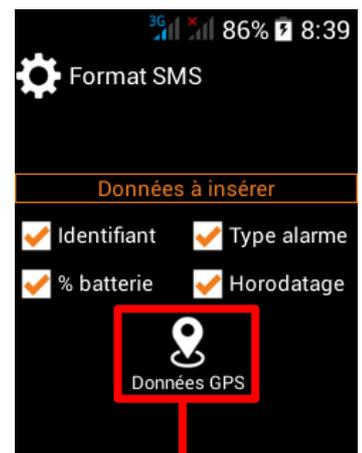
Dans le cas d'un appareil **avec option GPS**, l'icône « Données GPS » est visible et donne accès à la liste des données GPS qui peuvent être insérées dans le SMS. Il s'agit de la dernière position GPS que l'appareil a enregistré avant la création du SMS. Appuyer sur l'icône pour accéder au menu.
