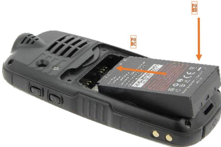
**FO 83** Utiliser uniquement la batterie fournie avec votre téléphone. Modèle : BL360CI Li-ion Batterie 3.7V DC / 3600 mAh. Pour tout remplacement de batterie, contacter le service après-vente de votre revendeur.
