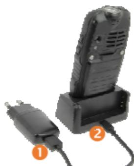
Insérer le câble USB dans le chargeur et à l'autre extrémité, le connecteur micro USB dans la station d'accueil. Positionner l'appareil sur la station d'accueil. Le voyant vert frontal de la station d'accueil doit passer au rouge au bout de deux secondes. Une fois la charge complète, il repasse au vert.
