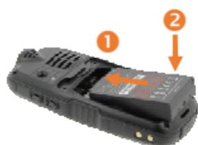
Aligner les contacts de la batterie puis l'enfoncer dans son logement. Repositionner le capot batterie et tourner sans forcer les vis de sécurité dans le sens des aiguilles d'une montre.
