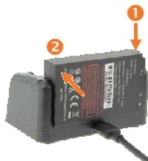
Aligner les connecteurs de la batterie sur le côté arrière droit de la station d'accueil puis la pousser pour l'insérer. Le voyant vert latéral passe au rouge pendant la charge. Une fois terminée, il repasse au vert.
