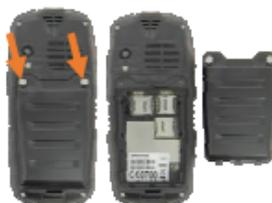
Tourner les deux vis de sécurité dans le sens inverse des aiguilles d'une montre jusqu'à ce qu'elles n'offrent plus de résistance.
